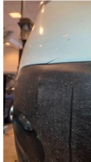
1.1 Liten skade på høyre hjørne foran
