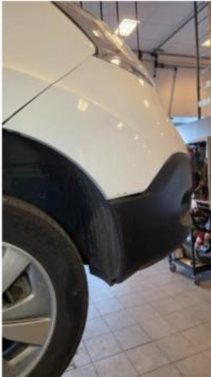
1.1 Liten skade på høyre hjørne foran
