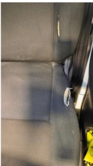
2.1 Slitasje på førersete og rygg
