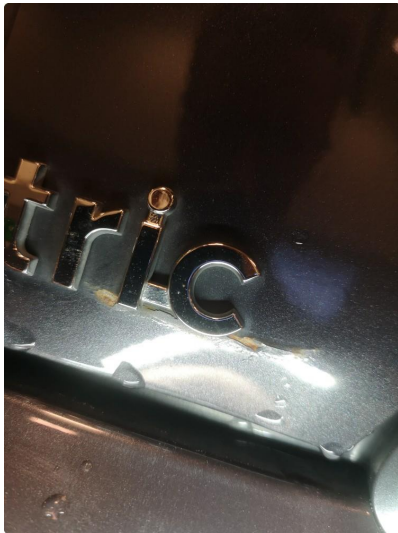
1.2 Påbegynnende korrosjon i bakluke
