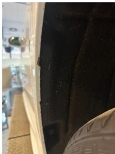
1.2 Noe rust på bakskjermer
