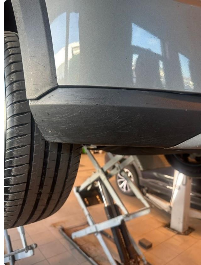
1.1 Litt oppripet på underside av fanger. Høyre foran
