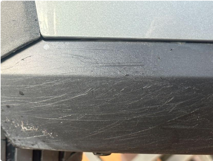
1.1 Litt oppripet på underside av fanger. Høyre foran
