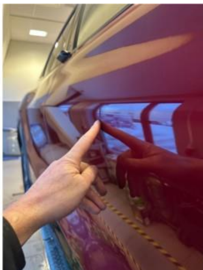
1.1 Noen små p.bulker i dør høyre foran
