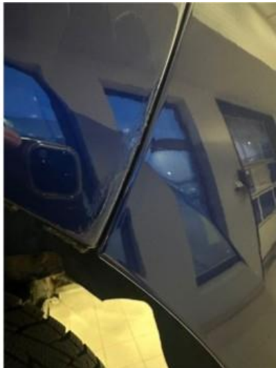
1.1 Litt antydning til rustdannelse på begge skjermene bak. Pusses og lakkeres forenklet.
