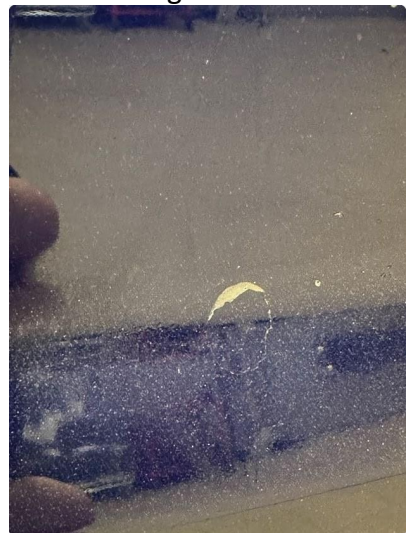
1.3 Noen små sprekker og lakkskader i fanger foran
