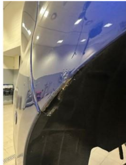
1.1 Litt antydning til rustdannelse på begge skjermene bak. Pusses og lakkeres forenklet.
