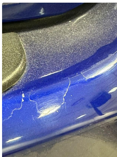
1.3 Noen små sprekker og lakkskader i fanger foran
