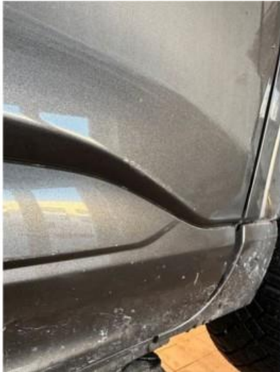
1.1 Litt oppripet på nedre del av dør høyre foran
