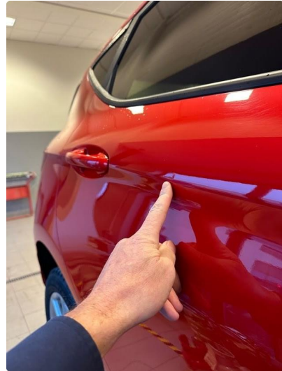
1.1 Liten p-bulk i dør høyre bak
