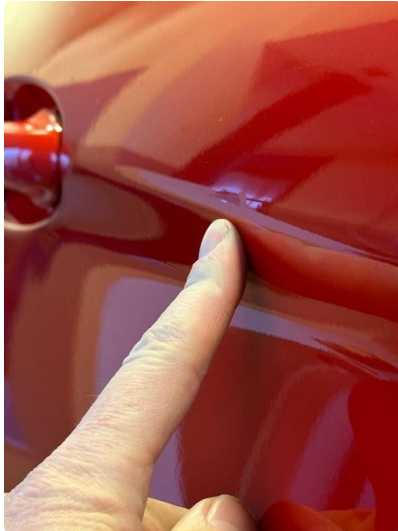
1.1 Liten p-bulk i dør høyre bak
