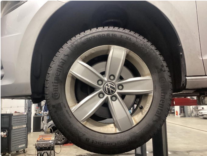
1.1 Hjul montert i feil kjøreretning
