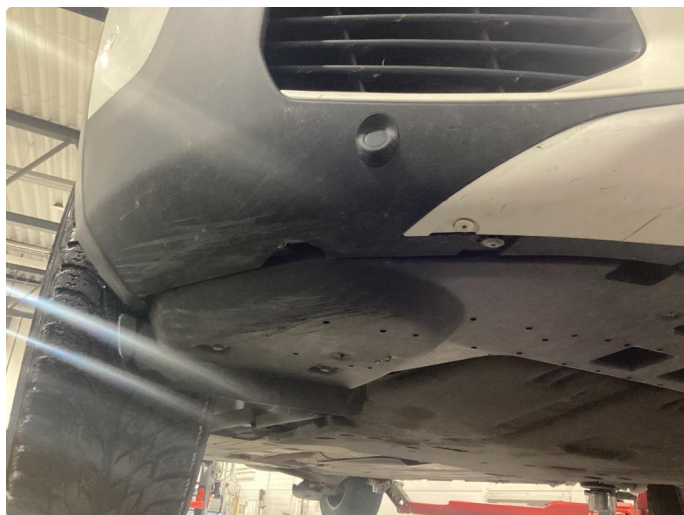
1.4 Små skrubbskader underkant
