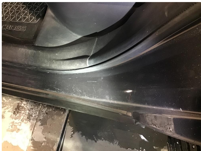
1.4 Noen små riper døråpning
