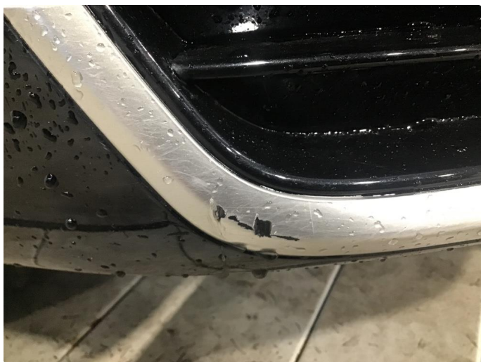
1.7 Noen små steinsprut fanger foran.
