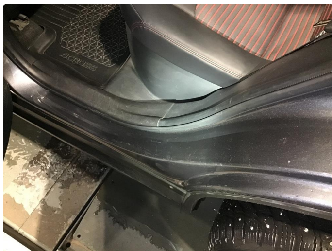
1.4 Noen små riper døråpning
