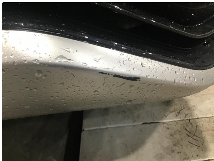
1.7 Noen små steinsprut fanger foran.
