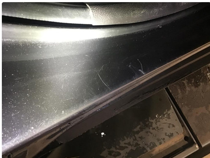
1.5 Noen små riper døråpning
