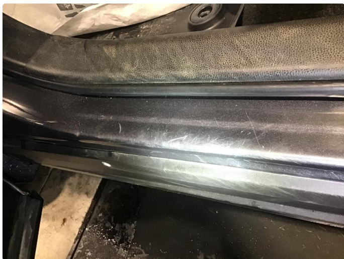
1.3 Noen små riper døråpning
