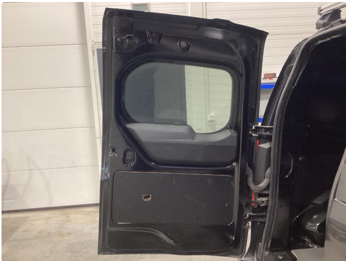
2.1 Skadet/merker etter utstyr
