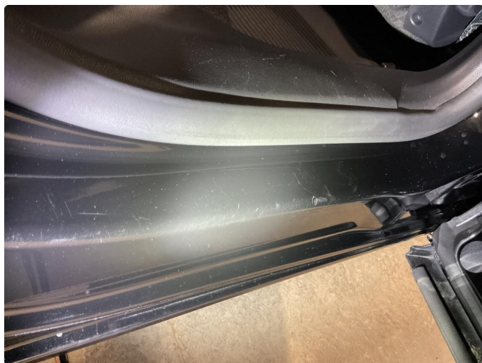
1.5 Noen bruksmerker innsteg
