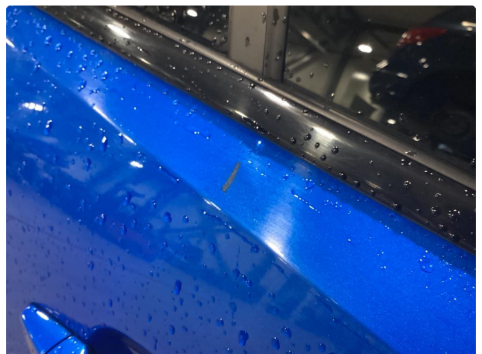
1.2 Noen små riper dører, poleres
