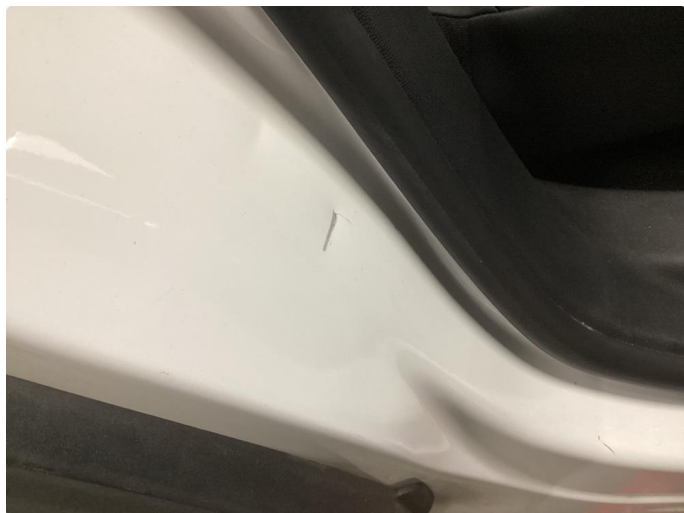
1.2 Bulk med lakkskade i dør, flekkes
