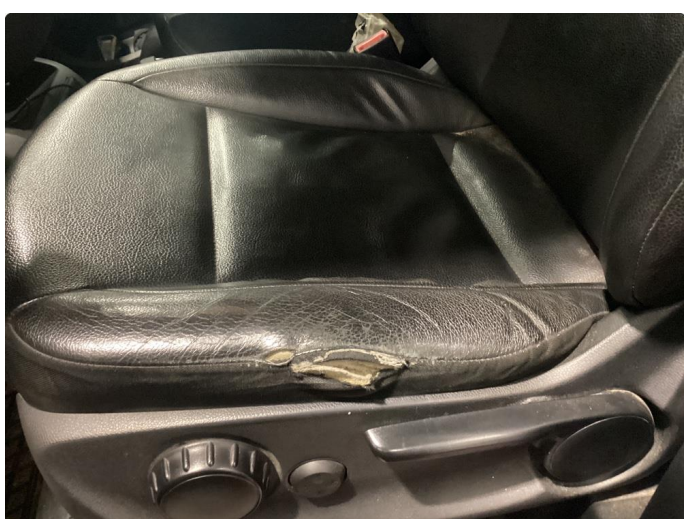
3.1 Skade på setetrekk
