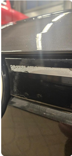
2.1 Dugg/fukt Fukt i ledstripe mellom hovedlykter foran
