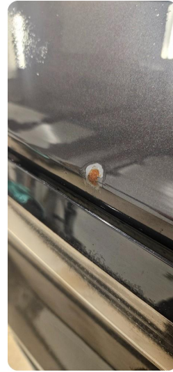
1.2 Øvrige feil Lakkskade med rust i bakluke
