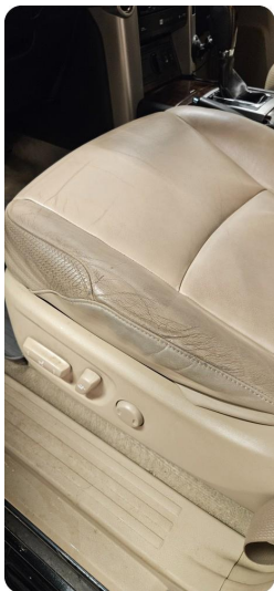
4.1 Slitt Noe slitasje på gearkule, trekk sittepute førerstolet samt ripe i deksel innvendig dørhåndtak. Vurderes av selger
