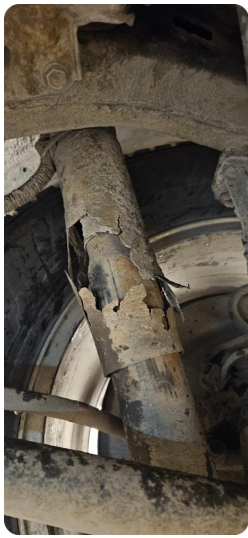
3.1 Støvmansjett defekt Mansjetter (stål) på begge bakre støtdempere er skadet av rust
