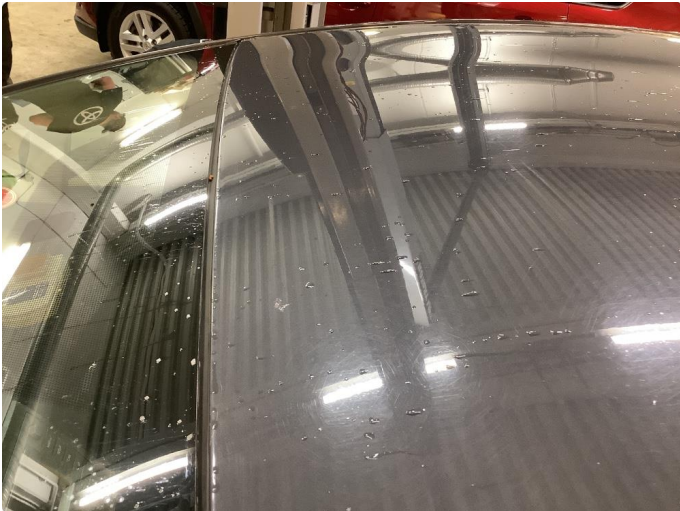
1.1 Steinsprut med rust
