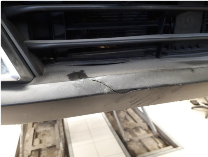
1.3 Liten skade nedre del støtfanger foran
