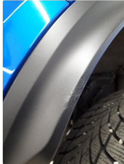
1.2 Skjermutbygger plast høyre bak riper.
