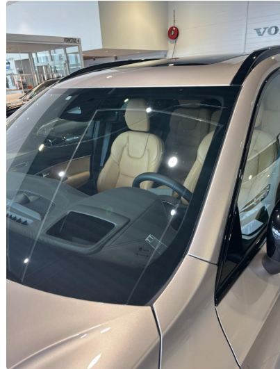
1.2 Steinsprut med sprekk - skiftes
