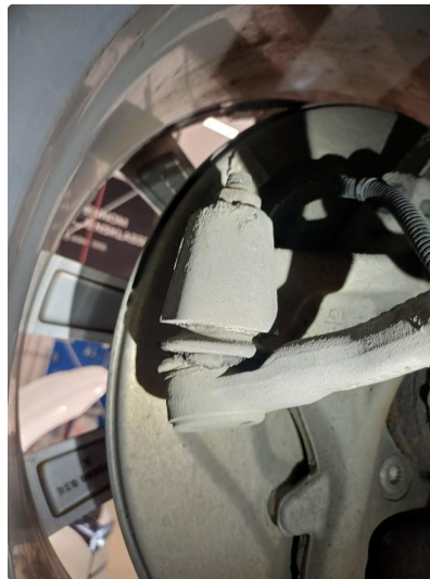
2.1 Mansjett defekt - Styrekule skiftes
