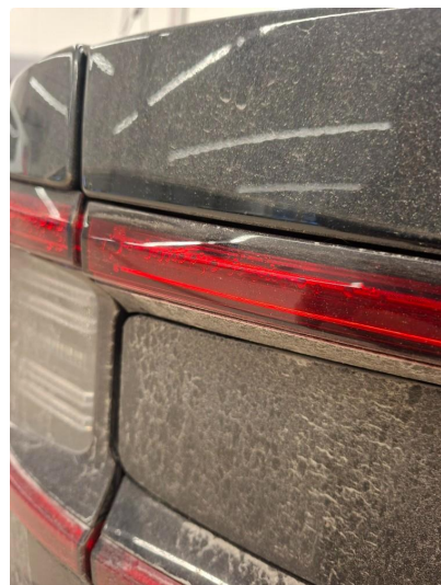
1.1 Dugg/fukt - skiftes på garanti
