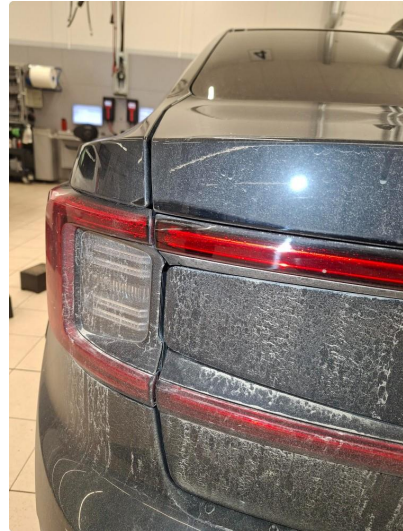
1.1 Dugg/fukt - skiftes på garanti
