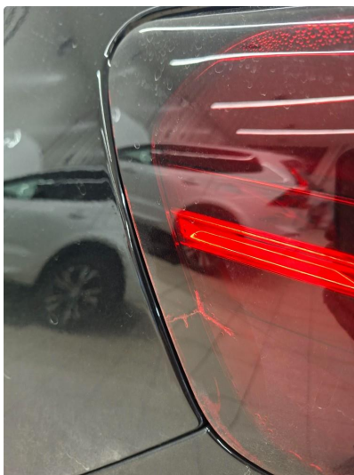
1.1 Dugg/fukt - skiftes på garanti
