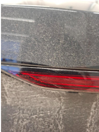
1.1 Dugg/fukt - skiftes på garanti
