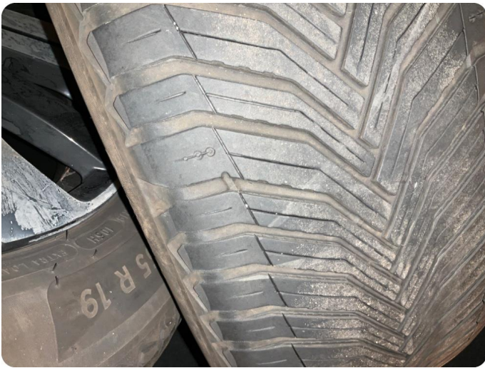
1.1 Skjev slitasje på sommerdekk
