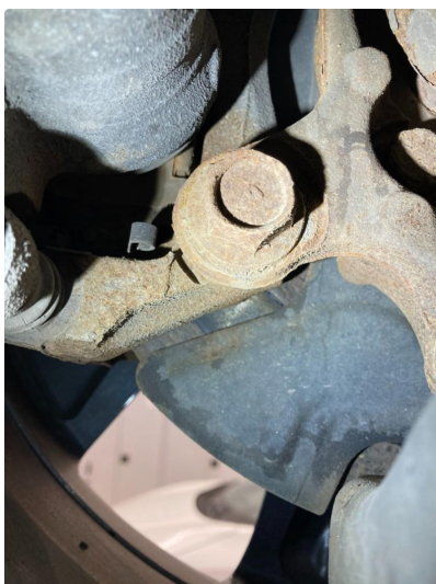
3.1 Overflaterust innside bremseskiver foran etter vask - bremses bort.
