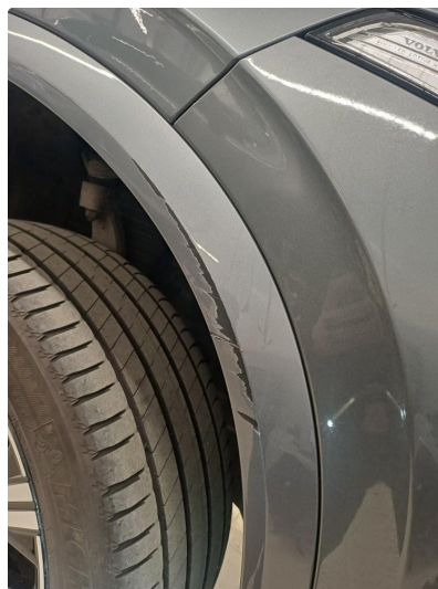
1.2 Skjermutbygger skadet - lakkeres
