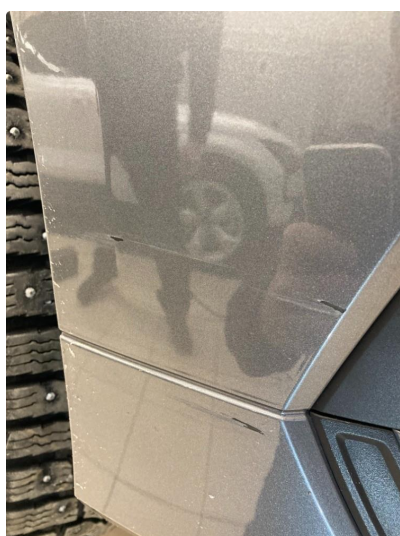
1.4 Ripe(r) ned til grunning. Flikk lakk reparasjon.
