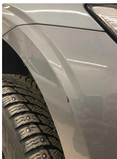
1.4 Ripe(r) ned til grunning. Flikk lakk reparasjon.
