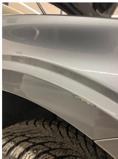
1.3 Ripe(r) ned til grunning. Flikk lakk reparasjon.
