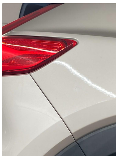
1.2 Ripe(r) ned til grunning. Skal utbedres.
