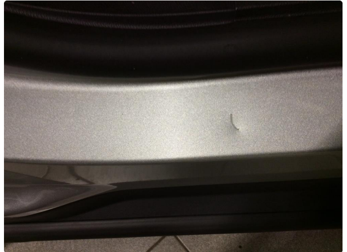
1.2 Bulk med lakkskade i døråpning
