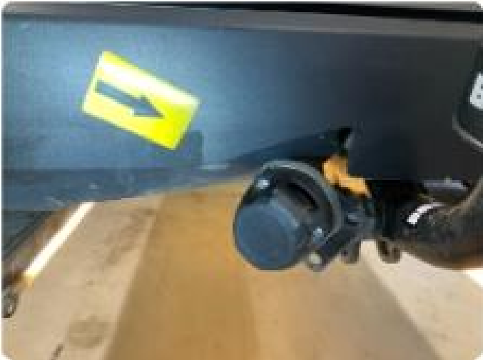
1.1 Sprekk i bakfanger bak hengerfeste
