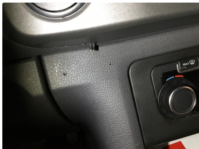
5.1 Skadet/merker etter utstyr
