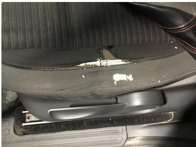
5.3 Skade på setetrekk
