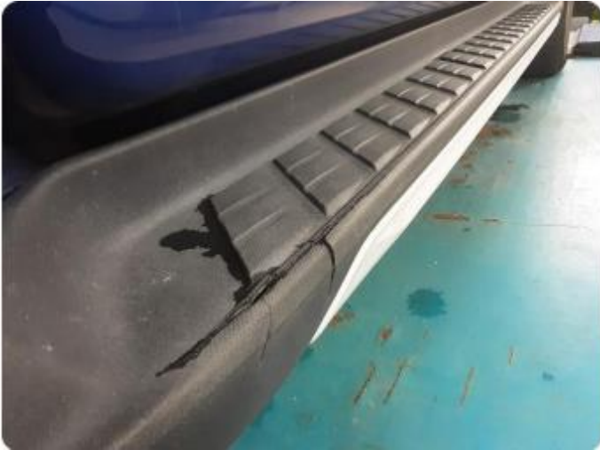
1.1 Skade på stigtrinn
