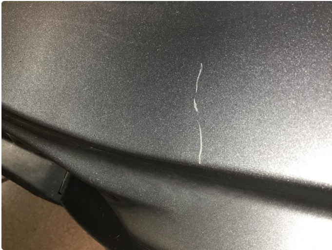
1.1 Noen riper og småbulker i døråpning
