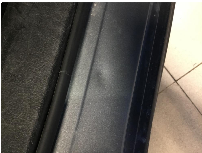
1.1 Noen riper og småbulker i døråpning
