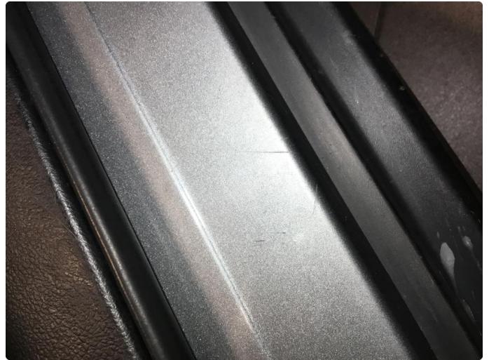
1.1 Noen riper og småbulker i døråpning
