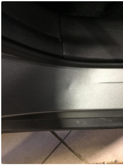
1.1 Noen riper og småbulker i døråpning
