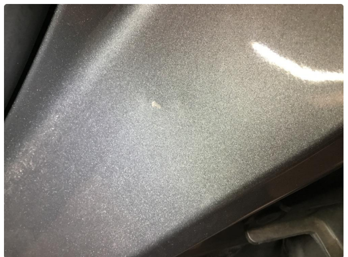
1.1 Noen riper og småbulker i døråpning
