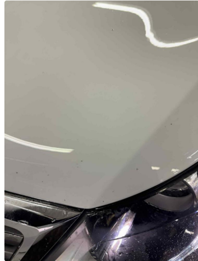
1.2 Noe steinsprut i panser
