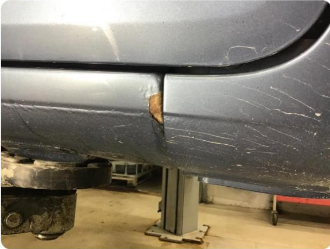
1.1 Korrosjon i kanal
