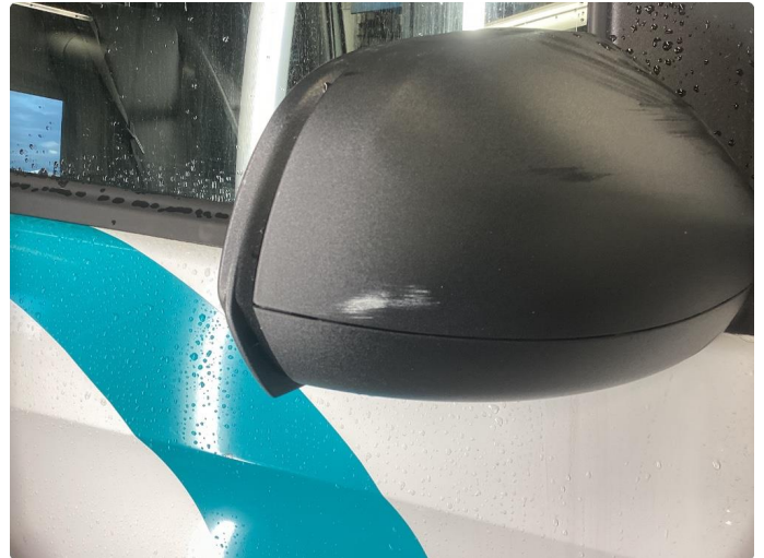
1.1 Noe bruksslitasje, normal iht. alder/km.
