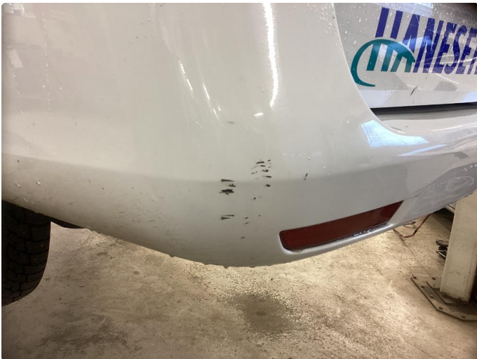
1.2 Noe bruksslitasje, normal iht. alder/km.
