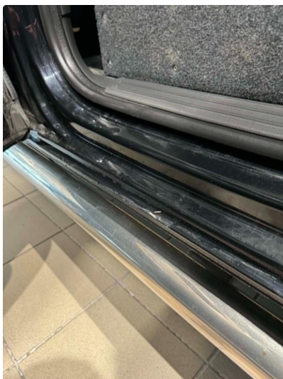
3.2 Normal slitasje i døråpning iht alder, km og bruk
