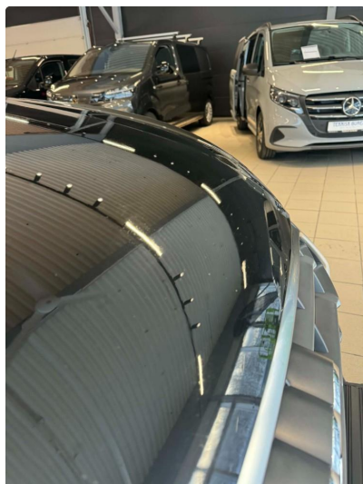
1.1 Noe steinsprut i panser - Normal slitasje
