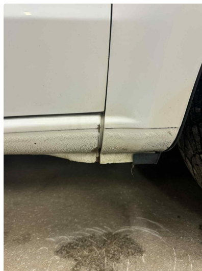
1.3 Mindre korrosjon i kanal, normal slitasje
