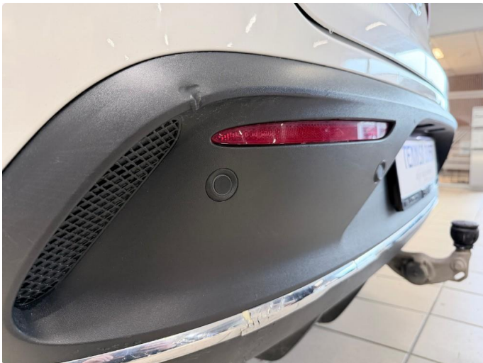
1.2 Liten skade i fanger bak
