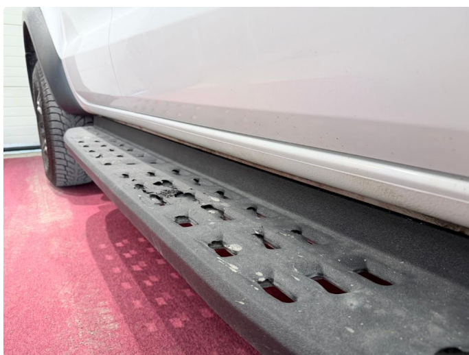
3.1 Noe slitasje på innstegsflate
