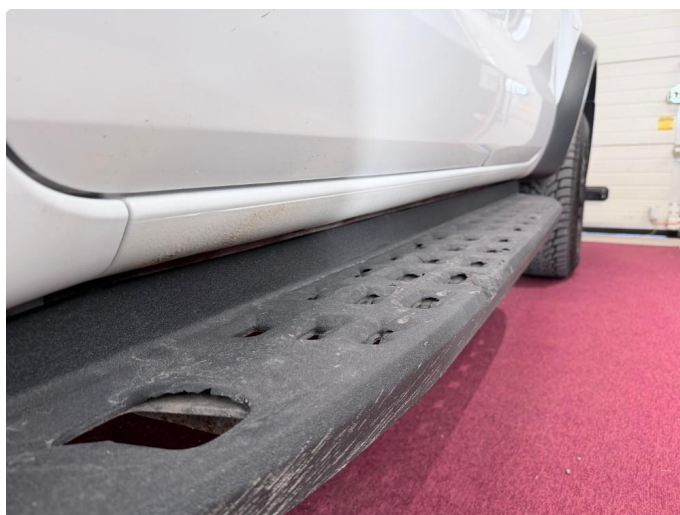
3.1 Noe slitasje på innstegsflate
