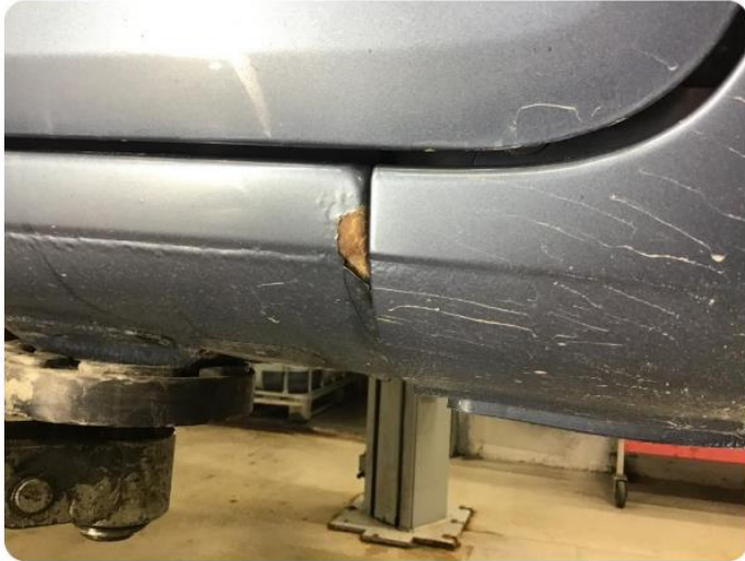
1.1 Korrosjon i kanal
