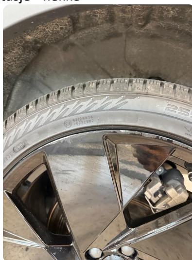
1.3 Kantkjørt felg Unormal slitasje - 3stk vinterhjul felger
