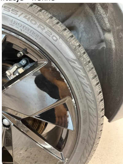
1.3 Kantkjørt felg Unormal slitasje - 3stk vinterhjul felger
