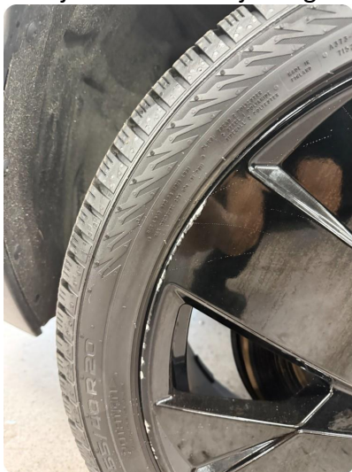
1.3 Kantkjørt felg Unormal slitasje - 3stk vinterhjul felger
