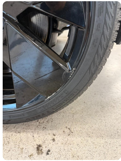
1.3 Kantkjørt felg Unormal slitasje - 3stk vinterhjul felger
