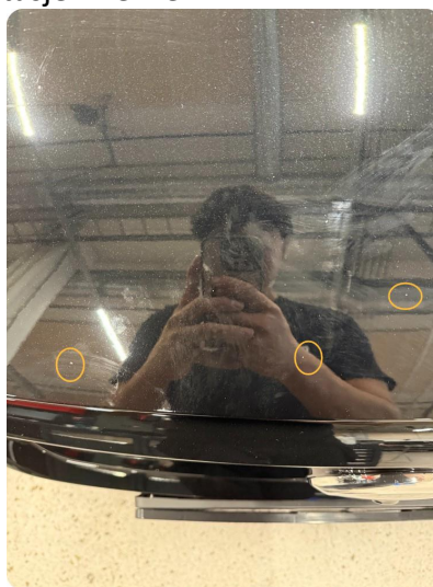
1.1 Steinsprut Normal slitasje - flekke
