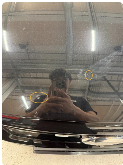
1.1 Steinsprut Normal slitasje - flekke
