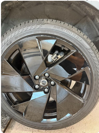
1.3 Kantkjørt felg Unormal slitasje - 3stk vinterhjul felger
