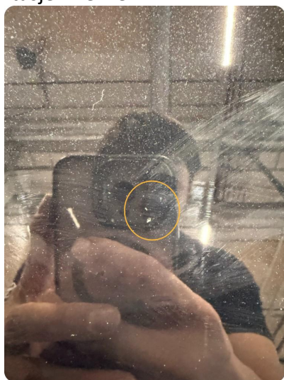
1.1 Steinsprut Normal slitasje - flekke
