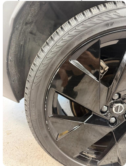
1.3 Kantkjørt felg Unormal slitasje - 3stk vinterhjul felger
