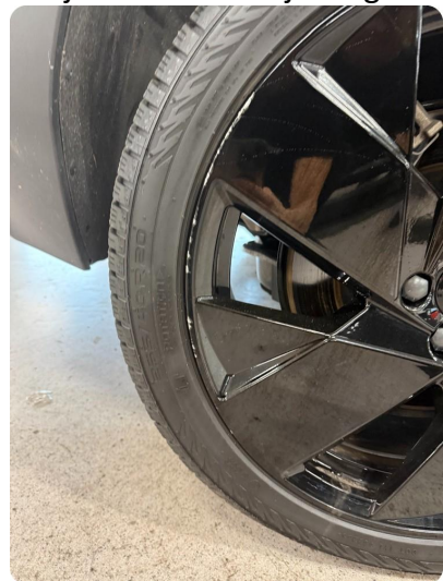
1.3 Kantkjørt felg Unormal slitasje - 3stk vinterhjul felger
