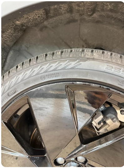
1.3 Kantkjørt felg Unormal slitasje - 3stk vinterhjul felger
