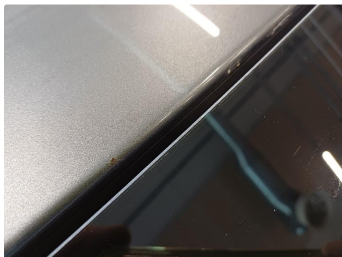
1.4 Steinsprut med rust
