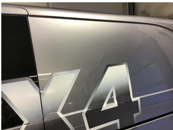
1.3 Flere bulker V.B Skjerm
