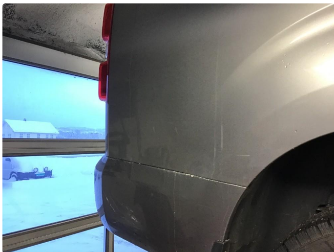
1.6 Noe riper og sår bak fanger
