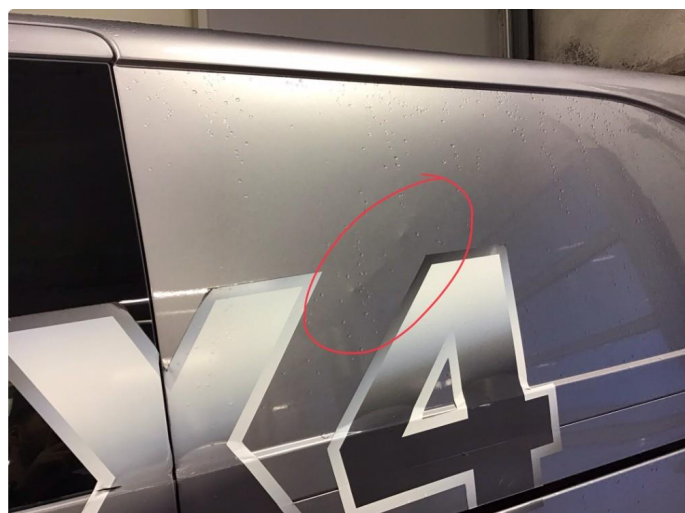
1.3 Flere bulker V.B Skjerm
