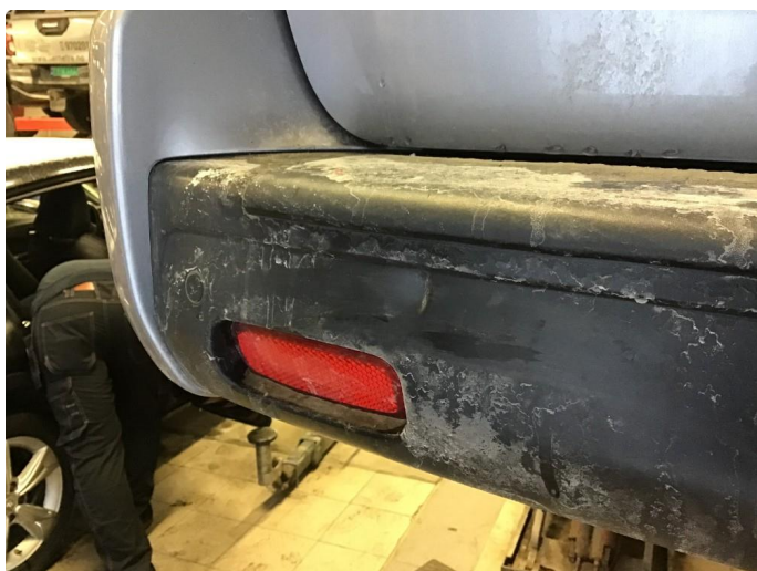
1.6 Noe riper og sår bak fanger
