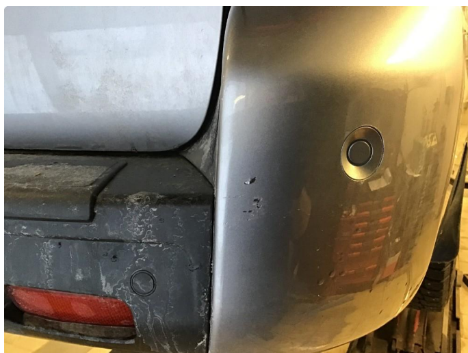
1.6 Noe riper og sår bak fanger
