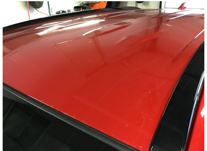
1.3 Noe steinsprut på tak
