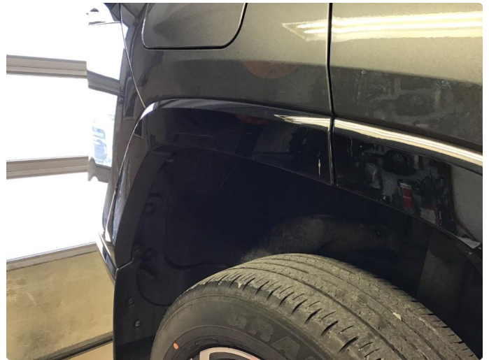
1.3 Skjermutbygger skadet H.B
