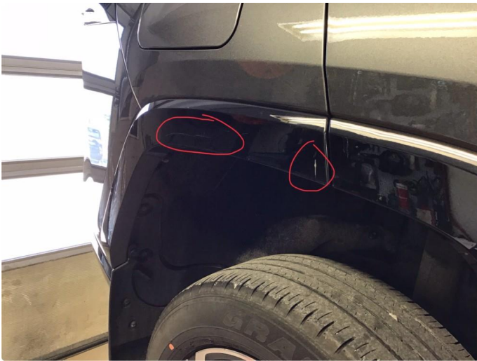
1.3 Skjermutbygger skadet H.B
