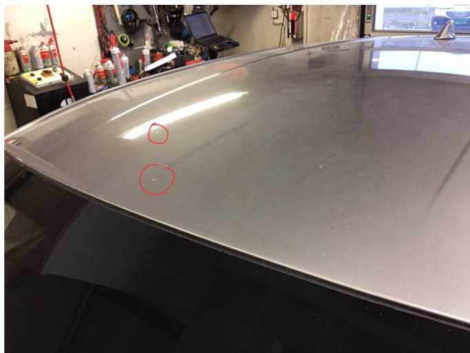
1.6 Noe steinsprut på tak.
