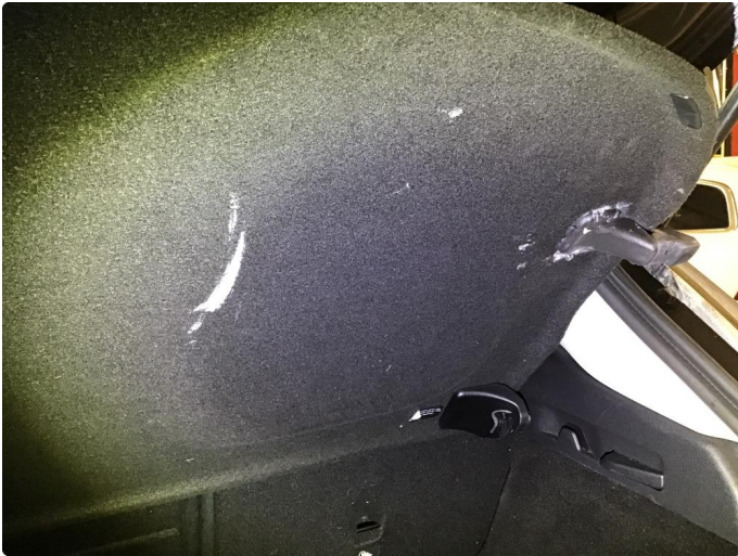
2.3 Flekker på hattehylle i bagasjerom
