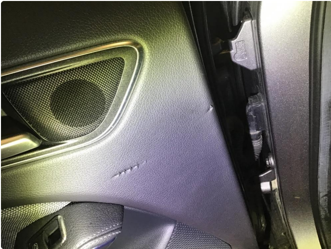
2.1 Skadet dørtrekk venstre bak
