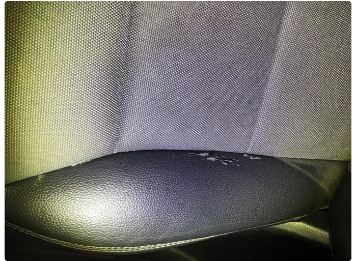
2.2 Skade på setetrekk førersetet
